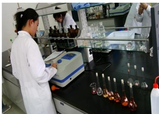
学生做邻二氮菲法测微量铁实验
